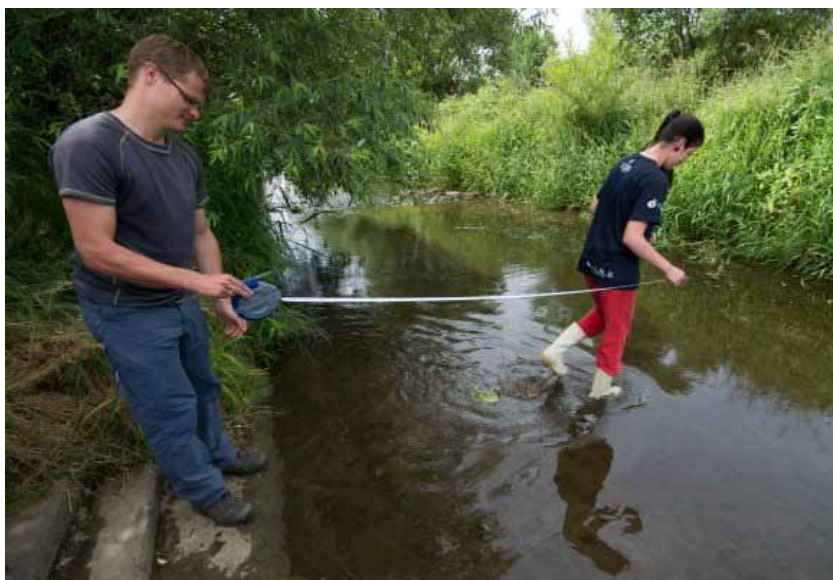
Obr. 33: Měření profilu koryta (CIV, 2014)
